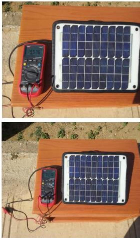
Figura 2 y 3: Medición del Voltaje y la Corriente a la salida de la fotocelda.
