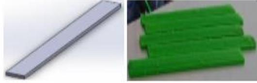
Fig. 13 Probeta para ensayo de flexión
