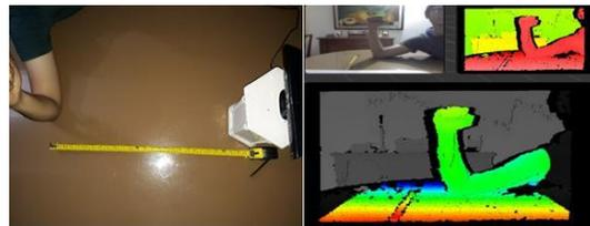
Fig. 3 Escaneado a 70 cm de la extremidad
