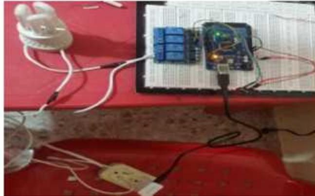
Figura 9: Prototipo funcional apagando el bombillo.
